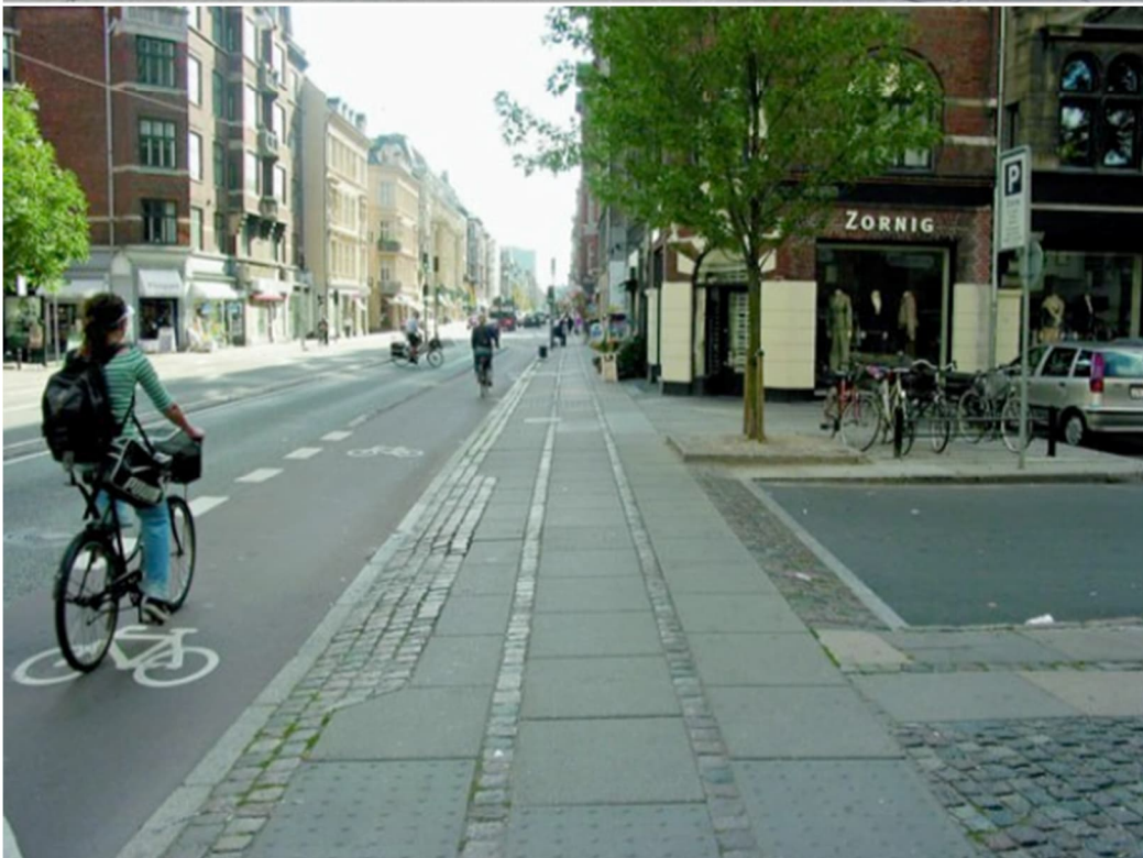
Figures 6 et 7. Continuité du trottoir sur certaines artères pour marquer les différences de vitesse entre le réseau artériel et le réseau local. Copenhague, Danemark. 5
